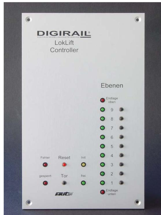
Für die manuelle Bedienung gibt es den LokLift Controller in der Ausführung für 9- oder 15 Ebenen.
