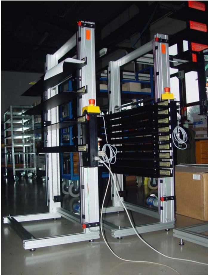
Auf diesem Bild sind bezogen auf die verschiedenen Spurgrößen zwei Extreme zu sehen: Der linke LokLift ist eine Ausführung für vier Ebenen für Spur 1, der dahinter stehende ist einer mit neun Ebenen für Spur Z.
