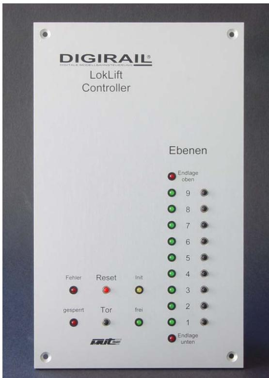
Für die manuelle Bedienung gibt es den LokLift Controller für 15 Ebenen. Die Steuerung erfolgt damit wie beim vertrauten Fahrstuhl.
