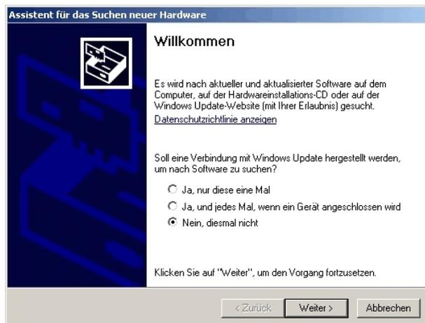
Verbinden Sie jetzt die SC02 mit einem passenden Kabel mit Ihrem Computer. Eine Spannungsversorgung an den Klemmen X1 ist für die reine Treiber - Installation dazu nicht nötig. Sie wird erst erforderlich, wenn Sie die SC02 in Betrieb nehmen.
