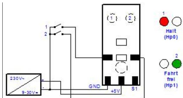
Bild 2: Testschaltung und Anzeigebilder des Moduls
