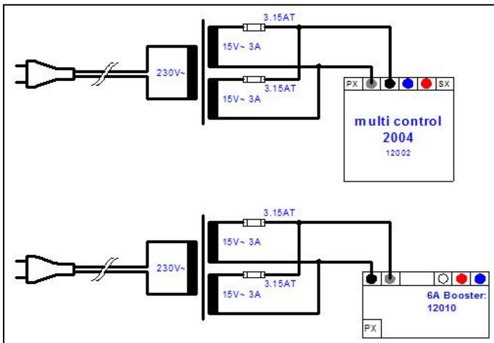
**Bild 2:** Durch Parallelschaltung der beiden Sekundärwicklungen kann eine multi control 2004 oder ein 6A Booster versorgt werden. **Wichtig:** Es müssen die Klemmen 0 mit 0 und 15 mit 15 miteinander verbunden werden (s. Aufkleber am Trafo).
